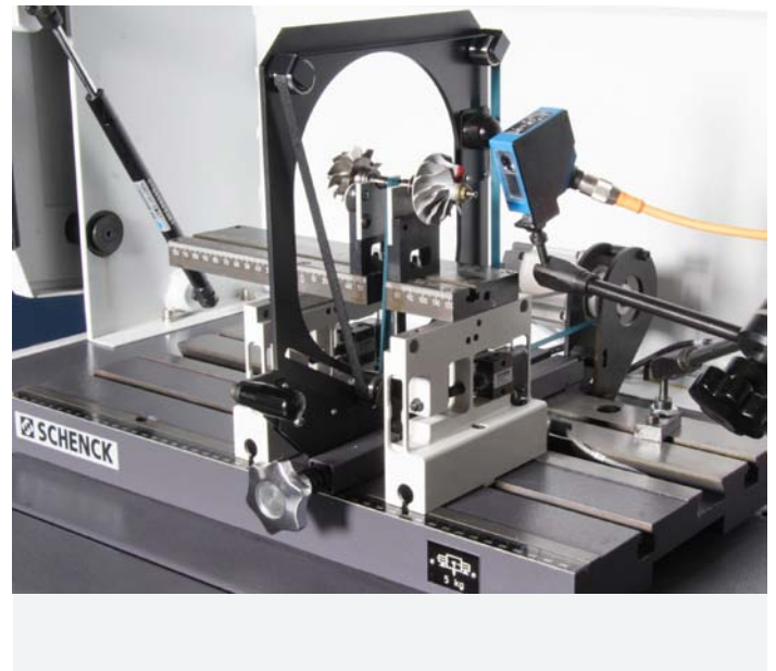
Prismenlagerung für kleine Turbolader Rotoren
