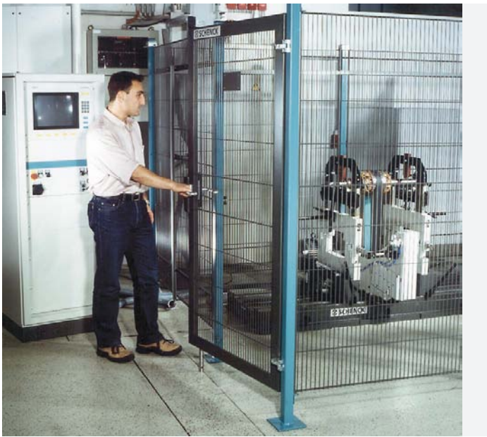
Sehr gute Zugänglichkeit an Rotor und Maschine werden mit einer Schutzeinrichtung der Klasse B erreicht. Die Schutzumzäunung erlaubt eine einfache Anpassung an jede räumliche Gegebenheit.
