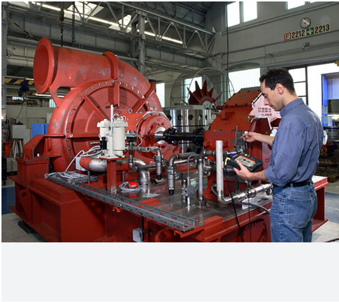
Betriebsauswuchten bei Fa. Siemens
