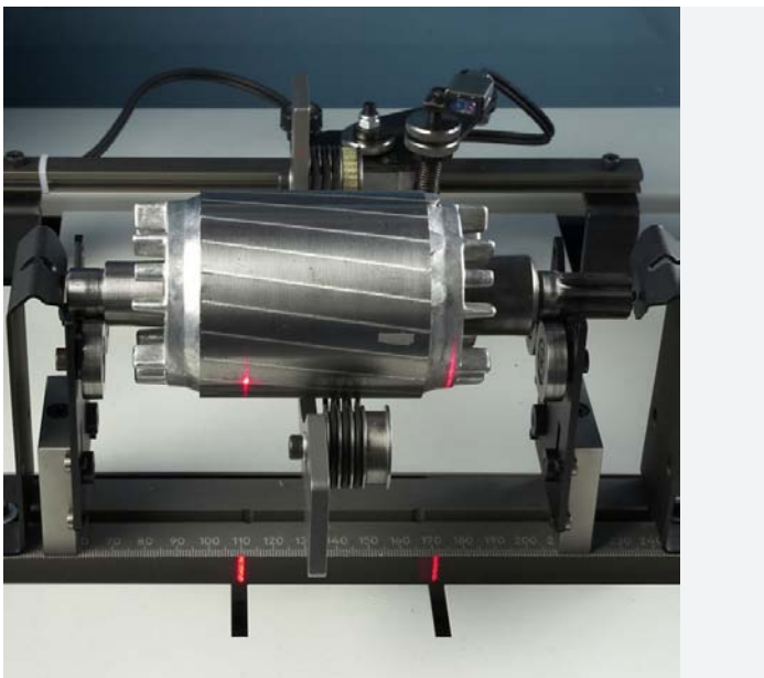
Der Linienlaser sorgt für eine deutliche Anzeige der Messebenen
