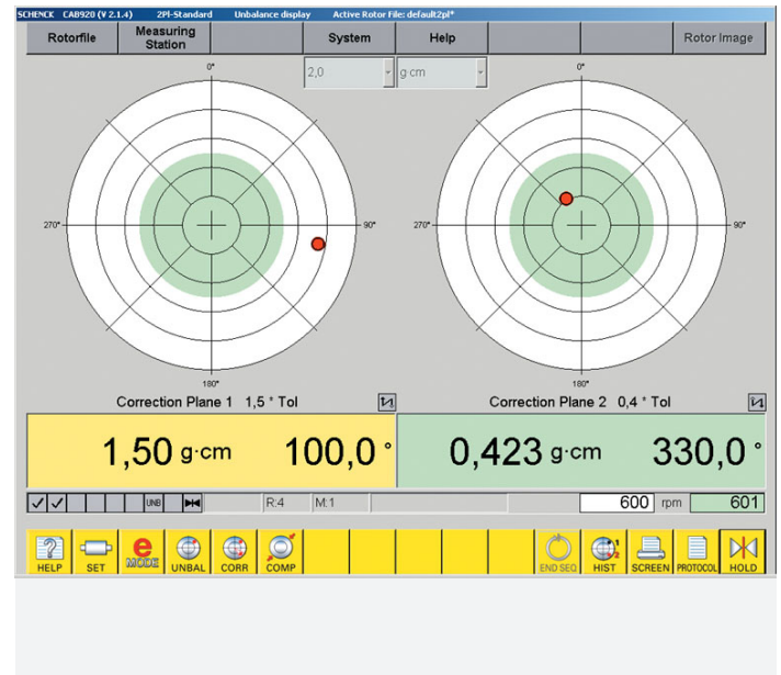
Eindeutige Anzeige der Unwucht vektoriell und numerisch - klare und farbliche Markierung, wenn die Toleranz erreicht ist
