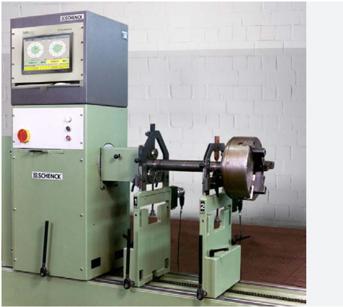
Das CAB 706 Modernisierungspaket eignet sich für vertikale und horizontale Auswuchtmaschinen in kraft- und wegmessender Ausführung
