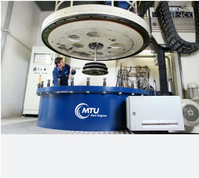
Betriebsfestigkeitsuntersuchung an einer Triebwerksstufe
