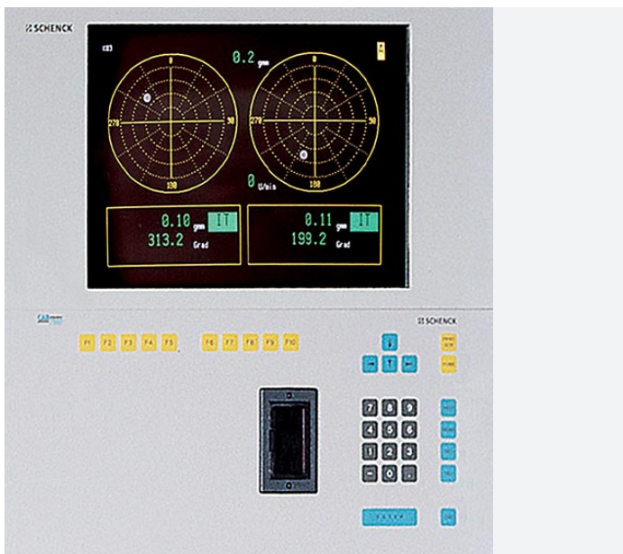
Das Messgerät mit digitaler Signalverarbeitung hat einen ergonomischen, grafikfähigen Farbbildschirm und eine integrierte Tastatur. Eine Bedienungsführung, weitgehend automatisierte Einrichtvorgänge und Diagnoseprogramme erleichtern die Bedienung. Softwaremodule zur Berechnung üblicher und komplexer Ausgleichsverfahren sind bereits installiert. Weitere Besonderheiten sind: Großer Typendatenspeicher, externe Schnittstelle.
