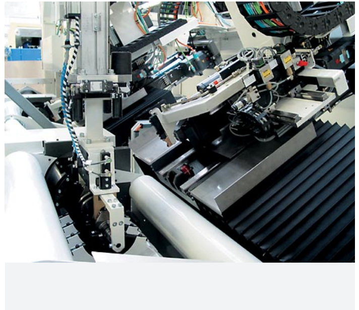
Ausgleichsstation mit leicht zugänglichen, horizontal angeordneten Bohreinheiten mit elektromechanischem Vorschub. Präzise Anschnittmeldung und Tiefensteuerung. Bohren mit Kühlmittel oder Öl. Spanneinheit komplett gekapselt ausgeführt, dadurch geringste Verschmutzung der Maschine durch Kühlfüssigkeit und Späne. Späneabfuhr wahlweise durch Unterflurabzug oder Späneförderer.
