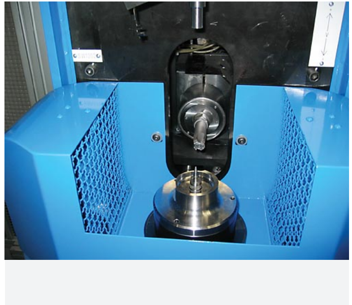
Der Unwuchtausgleich an der Nabe und der Rückseite der Laufräder erfolgt durch numerisch gesteuerte Fräseinheit.
