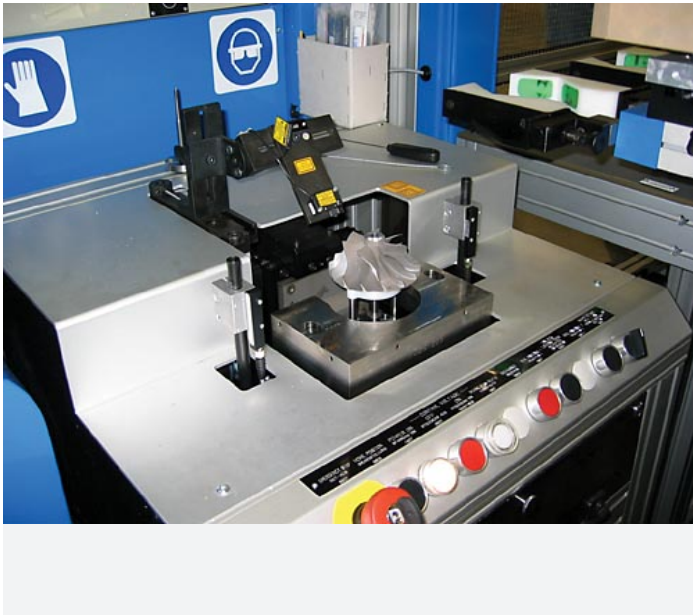
Messtation mit Luftlagerung für extreme Messgenauigkeit.
